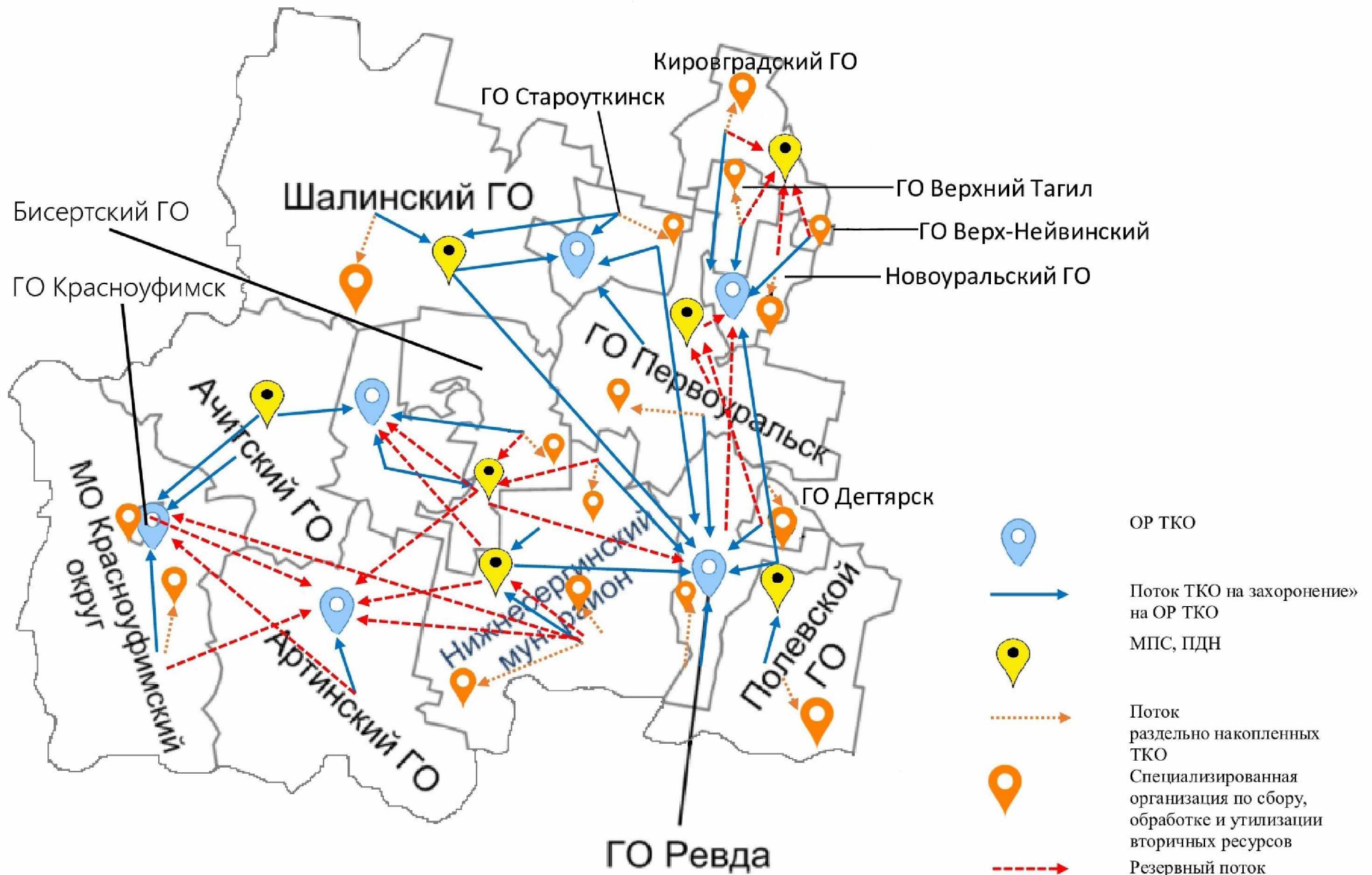
Рис. 6 Схема потоков ТКО АПО-2 (I этап)
